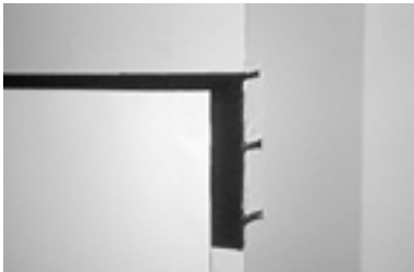
Aufschweißen auf Sika® Waterbar Fugenband
